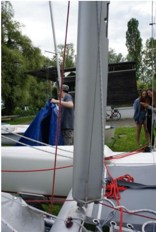
Mit der Persenning beginnen wir mit dem Einhängen des Großfalls in die Öse ca. in der Mitte des Trampolins, anschließend von Bug Richtung Heck schaffen und alle Riemen und Spanngummis einhängen.
