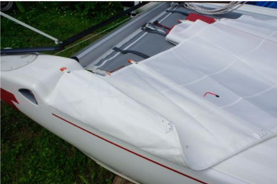
Ruderblätter aushängen und aufs Trampolin legen, **Spanngummis der Ruderanlage aushängen und Luckendeckel öffnen.**
