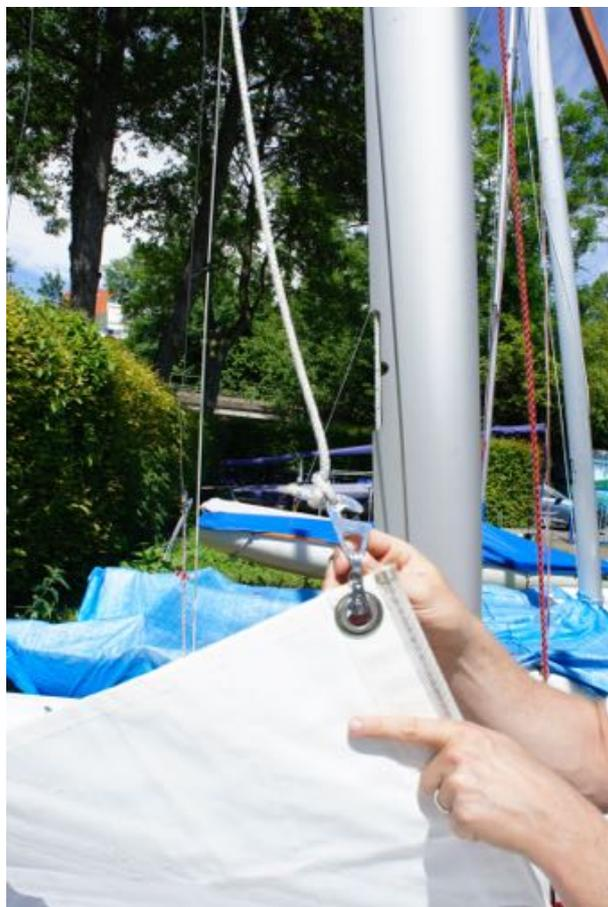
Das Großfall nun am Mastfuß herausziehen und in der Trampolinverschnürung nahe am Mast verstauen. Das untere Ende des Vorlieks in die Mastnut fädeln. **Der Vorliekstrecker und die Großschot werden erst auf dem Wasser eingehängt!**
